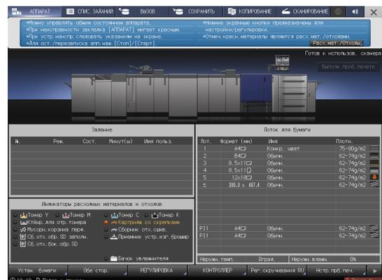
3 Нажмите на вкладке [Доб.сшив.] необходимого устройства изготовления брошюр, затем следуйте инструкциям в окне по замене картриджа со скрепками.
