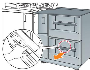
**2** Чтобы ослабить фиксаторы боковых направляющих (4 шт.), поверните их против часовой стрелки.**3** Нажимая на рычажок разблокировки боковых направляющих (1), переместите боковые направляющие пластины в нужное положение (2).
