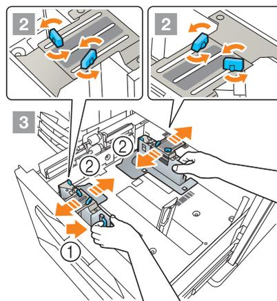
**4** Нажимая на рычажок разблокировки задней направляющей, переместите заднюю направляющую пластину в требуемое положение.
