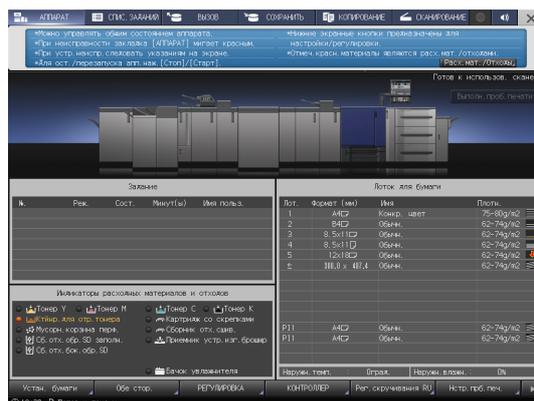
3 Нажмите вкладку [Отраб. тонер], затем следуйте инструкциям в окне по замене **контейнера для отработанного тонера**.
